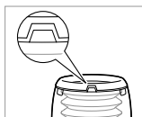
FIGURA 15 Per inserire la camera a soffietto nel corpo, l'apertura del corpo deve essere rivolta verso l'alto. Prestare attenzione che la camera a soffietto sia inserita bene.
