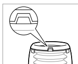
IMAGE 15 Tenez le boîtier avec l'ouverture vers le haut et insérez le soufflet. Faites attention à ce que le soufflet soit bien positionné.
